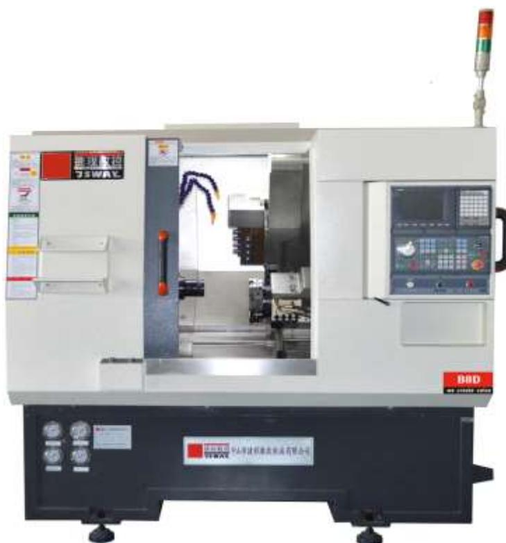
Токарные станки с ЧПУ компании JSTOMI представляют собой современное высокопроизводительное оборудование с револьверной головкой и приводными инструментами.
